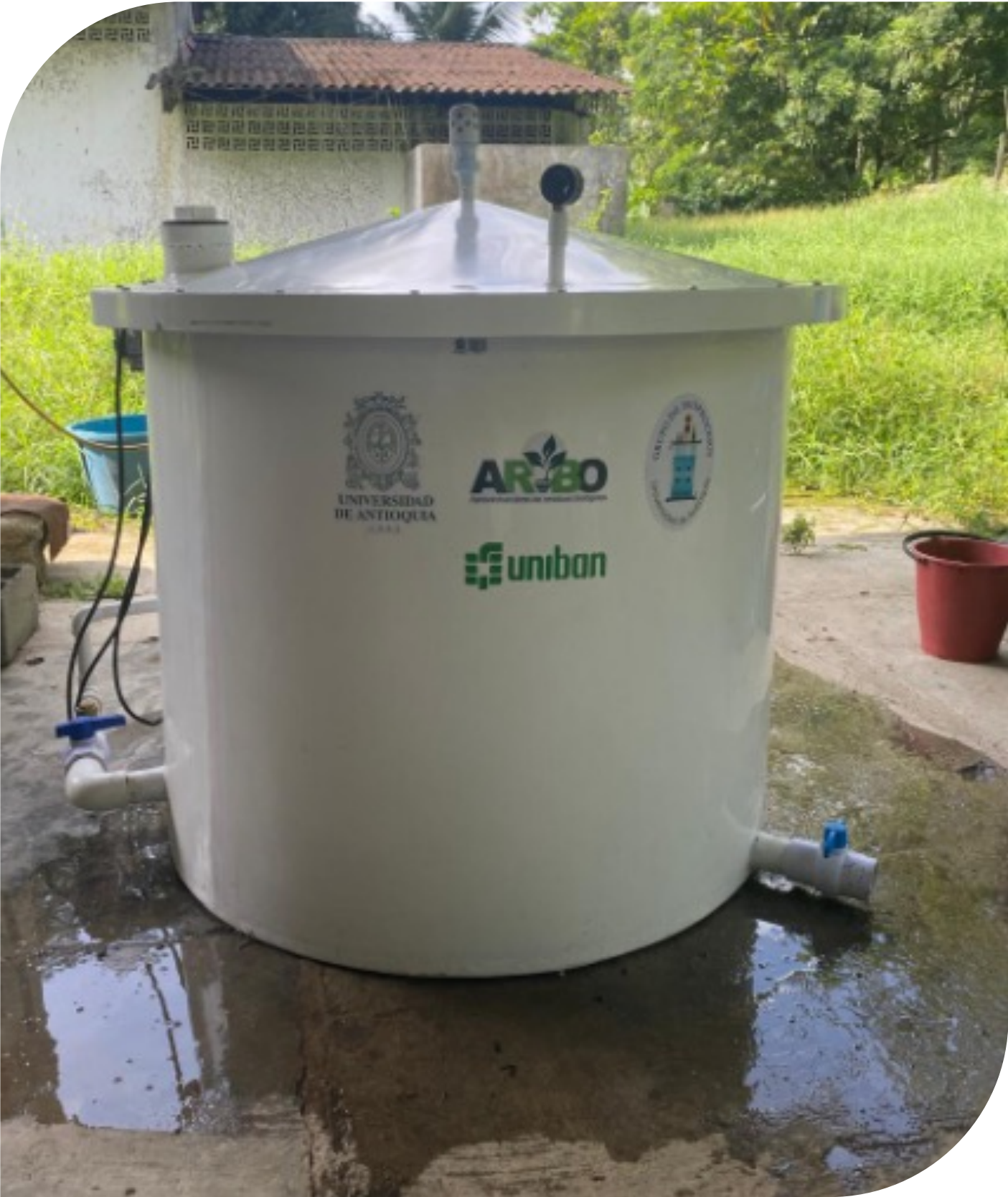
➔ Piloto de biodigestor.
